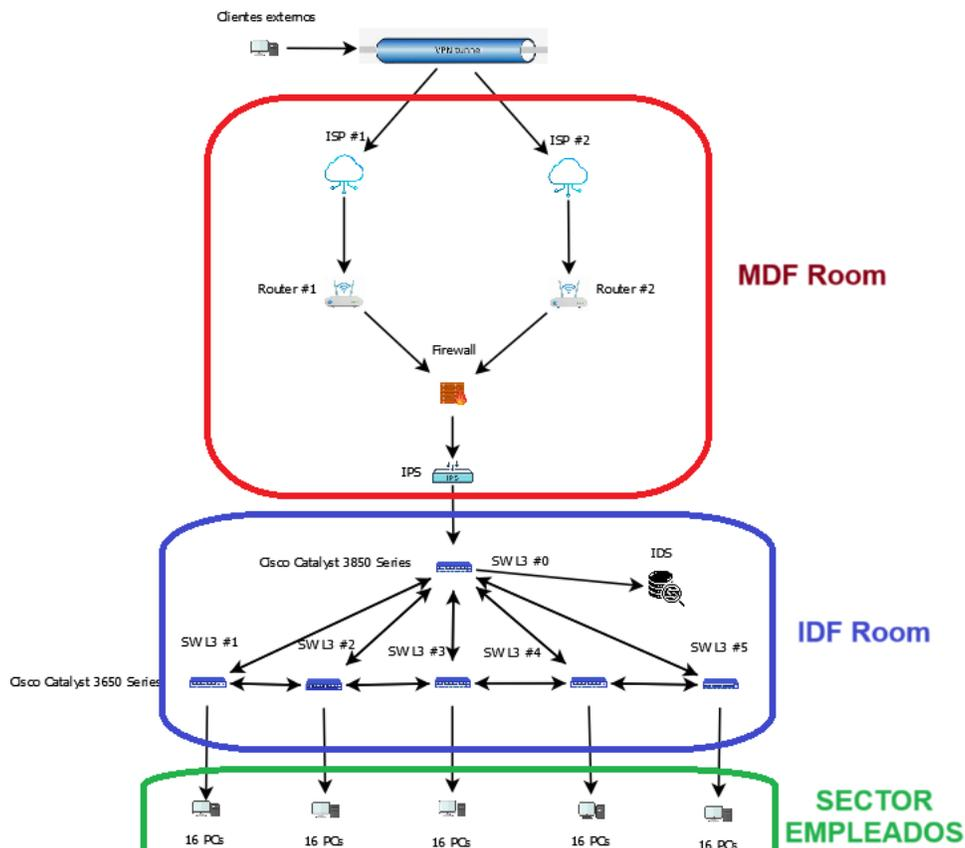
Como figura en la imagen, la red se encontraría distribuida en 3 sectores. Por un lado la conexión de los ISP, los 2 Routers principales, el Firewall principal y el IPS, se encontrarían dentro del MDF Room.
