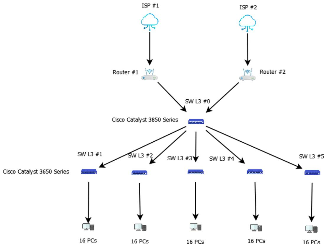
En este caso, cada uno de los cinco switches de capa 3 adicionales está conectado al Switch L3 principal. Cada uno de estos switches de capa 3 adicionales (Switch L3 #1, #2, #3, #4, y #5) está conectado a PCs. Dado que tenemos 16 PCs conectadas a cada uno de estos switches, necesitaremos al menos 17 puertos en cada uno de los switches adicionales para conectar las PCs y un puerto adicional para la interconexión con el Switch L3 principal.
