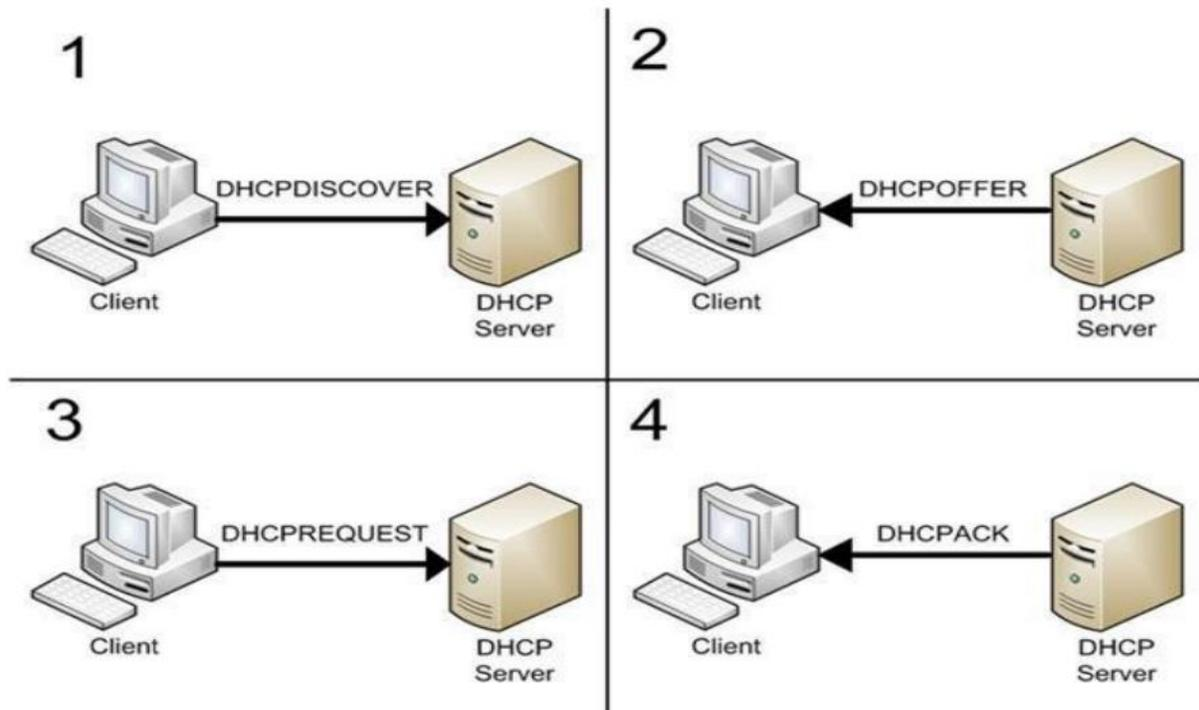
El dispositivo a conectar envía una petición al servidor DHCP "DHCPDISCOVER", el servidor DHCP le ofrece una configuración "DHCPOFFER", el dispositivo le solicita al servidor dicha configuración "DHCPREQUEST" y por último el Servidor DHCP carga la configuración en el dispositivo asignándole una IP que este dentro del rango seleccionado para DHCP "DHCPACK".
