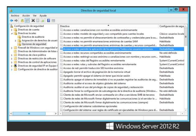
Esta configuración de seguridad determina los permisos adicionales que se conceden para conexiones anónimas al equipo.
