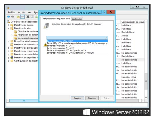
Esta configuración de seguridad determina el protocolo de autenticación desafío/respuesta que se usa para inicios de sesión de red. Esta opción afecta al nivel de protocolo de autenticación usado por los clientes, el nivel de seguridad de sesión negociado y el nivel de autenticación aceptado por los servidores de la siguiente manera:
